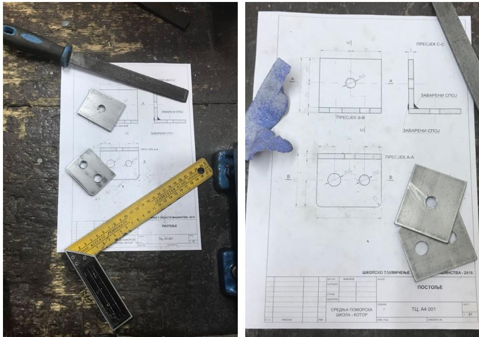
Slika 22. Tehnički crtež elementa za izradu
